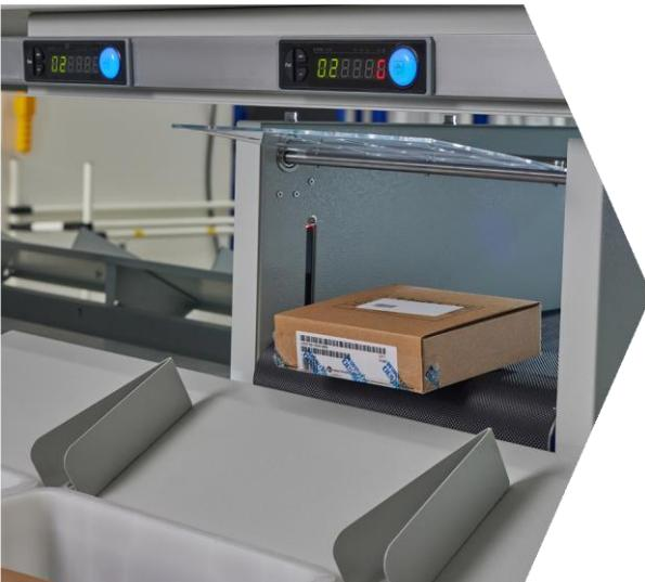
Puede aplicarse a una variedad de escenarios de clasificación, como entrega directa y devolución inversa, con una eficiencia mecánica de hasta 1.800 piezas/hora. Durante el funcionamiento del muro automático de siembra, puede mejorar la eficiencia de la clasificación y la selección inicial, reducir eficazmente la tasa de mala clasificación y la intensidad laboral de los empleados, y mejorar la eficiencia de la gestión del almacén. También es posible leer OCR o mediante lector RFID.
